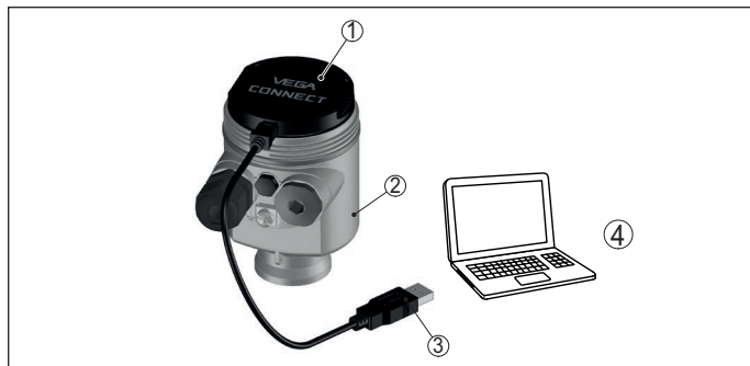
插图. 23: 通过 VEGACONNECT 和 USB 与电脑连接
