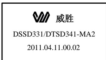
注：2011.04.11 为软件编制日期、00 为电流规格，表示电流规格为 1.5(6)A，02 为电压规格，表示电压规格为 57.7V，电流电压规格表如下：
