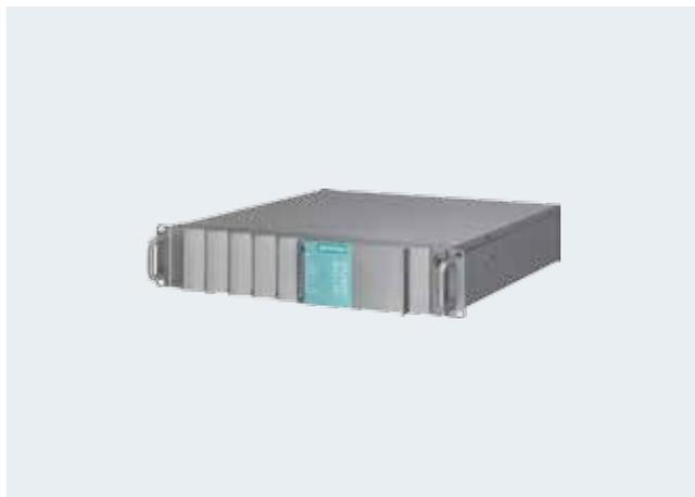
SIMATIC IPC647C 是一款结构坚固，且极为紧凑的工业 PC，具有 19 英寸的设计（2HU）。它尤其适用于在着重节省空间的场合执行快速计算以及可视化的任务，比如，图像和数据处理，或者工业服务器的应用。凭借其只有 2U 的高度以及较浅的安装深度，可以很好地使用在 19 英寸的标准控制柜当中（500 毫米或更深）。
