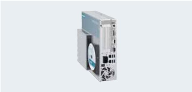
SIMATIC IPC627D 最新的第四代 Intel Core 处理器，最高支持至强 E3-1268Lv3 处理器。由于其极高的紧凑性和性能，能够在高达 55 °C 的环境温度下出色地执行测量、开环和闭环控制任务。
