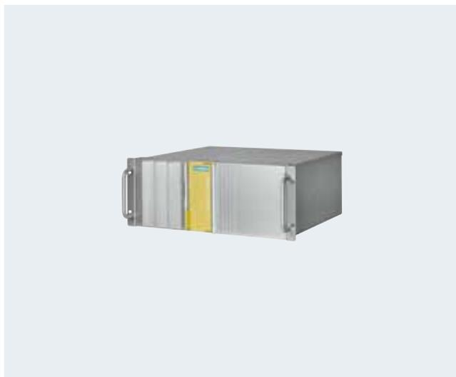
SIMATIC IPC547E 是一款功能强大且性价比高的工业 PC，19 英寸标准 4U 机架式设计，提供高至酷睿 i7-4770S 处理器，无须扩展情况下可直接连接 3 个显示器，最多可同时连接到 5 个显示器。可使用 RAID1 或 RAID5 配置，支持热插拔，前面板可支持到四个可插拔硬盘。可确保在环境温度高达 40 °C 的条件下 CPU24 小时全速运行。
