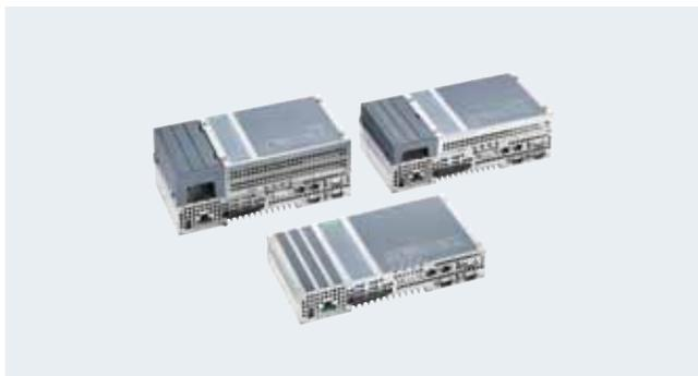
SIMATIC IPC427D 小型箱式 PC 是一款功能强大的嵌入式工业 PC，最高支持酷睿 i7-3517UE 处理器，支持标准导轨安装、墙式安装或者立式安装。可广泛应用于对安装空间要求极为苛刻的控制箱或者机械设备内部。免维护的无风扇设计大大提高设备的抗震抗冲击能力。
