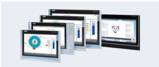
SIMATIC Industrial Flat Panel Monitor 是工业级宽屏显示器，有 15、19 和 22 寸屏幕供选，15 寸有带按键屏幕，19 寸提供多点触摸屏，170 度可视角。坚固耐用，非常适用于振动、冲击的工业环境。开孔尺寸与 SIMATIC 面板式 PC 相兼容。
